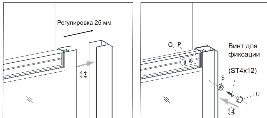
4.2) В завершении, установите душевой угол в нужное место, затяните винты и соедините внешний и внутренний профиль, после чего наденьте на винт декоративную крышку.
