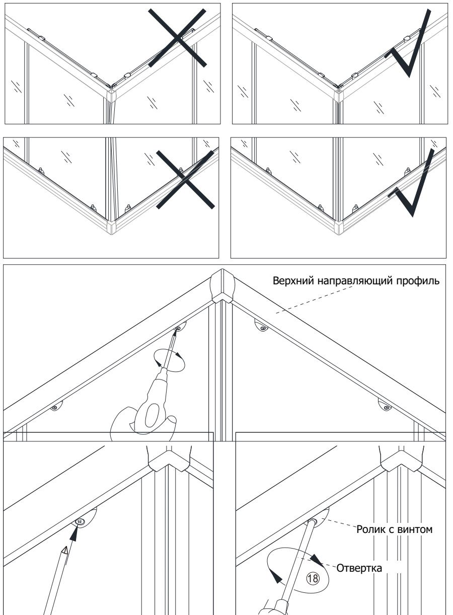
6.1) Пожалуйста, установите ролики раздвижной двери в алюминиевую направляющую. Если середина 2-х раздвижных дверей находится не по вертикали или, если после установки магнитной ленты между 2-я дверьми имеется зазор, следует отрегулировать винт на роликах с помощью отвертки, чтобы сдвижные двери плотно прилегали друг к другу
