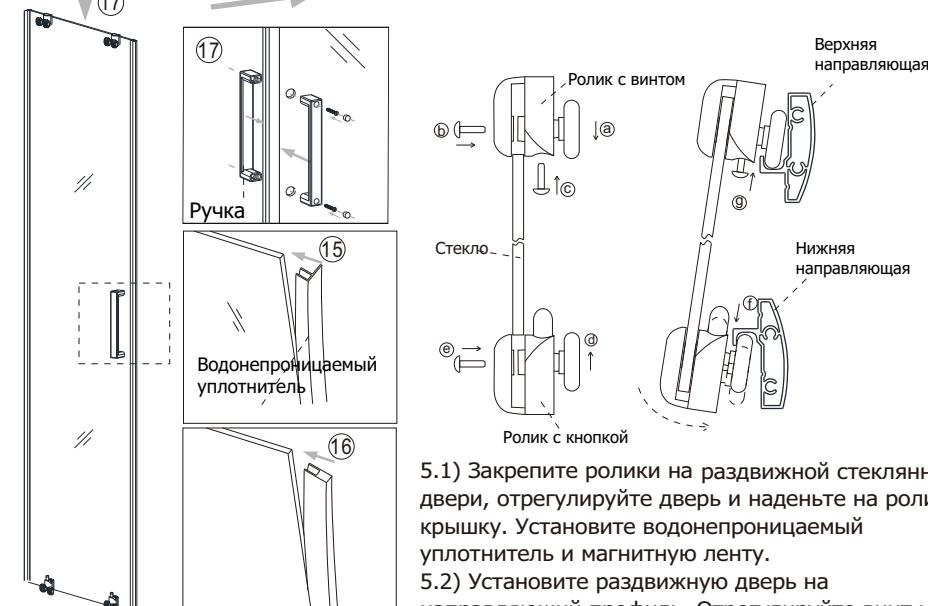
5.1) Закрепите ролики на раздвижной стеклянной двери, отрегулируйте дверь и наденьте на ролики крышку. Установите водонепроницаемый уплотнитель и магнитную ленту.
