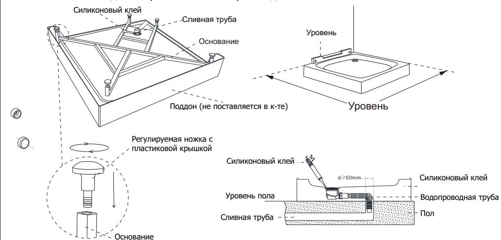
2.2) Проверьте сливное отверстие на предмет утечки воды; если оно пропускает воду, используйте, пожалуйста, силиконовый клей для его герметизации.
