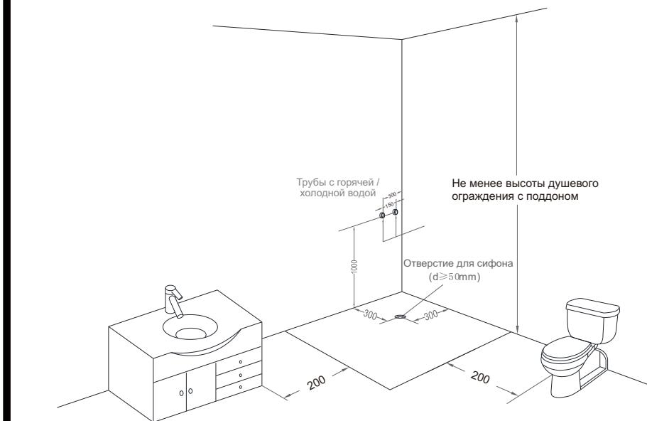
2.1) Сливное отверстие: для надлежащего отвода воды постарайтесь установить сливное отверстие в верхнем положении; если это не представляется возможным, слив должен находиться как минимум на высоте 20 мм, диаметр сливного отверстия должен быть менее 50 мм.
