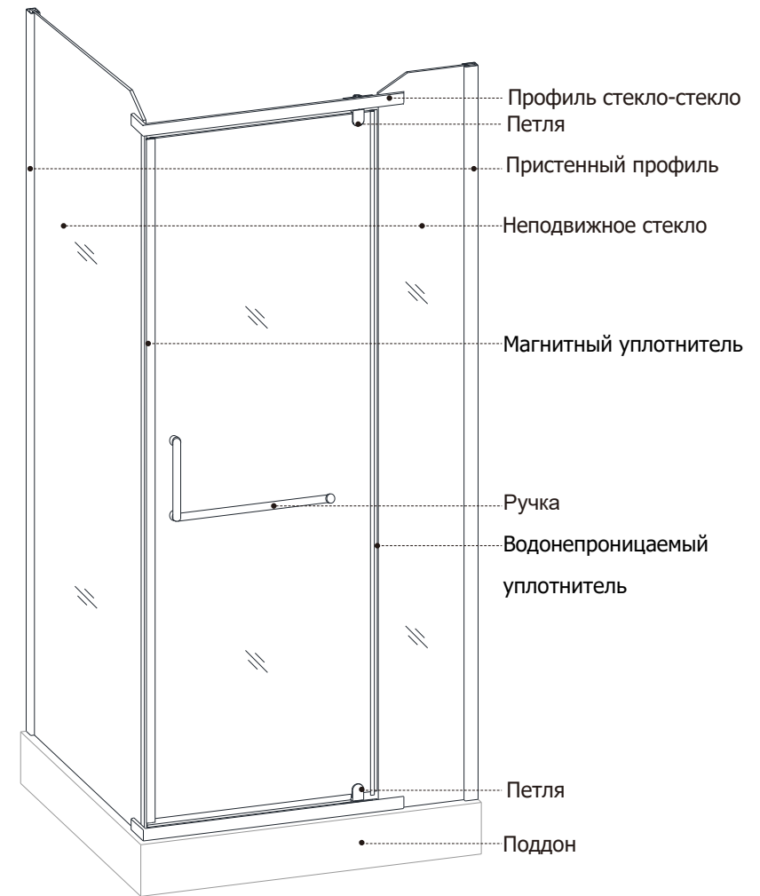
Общий вид душевого угла
