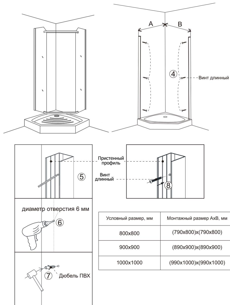
5.1) Установите душевой угол на поддон, отметьте место крепления, пристенных профилей и закрепите их на стене.
