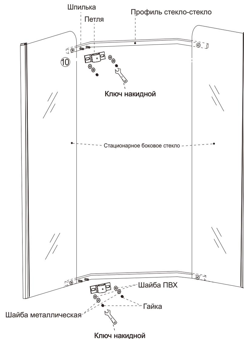
6.1) Закрепите петли на профиле стекло-стекло крепежными винтами дверного стекла внутрь кабины.
