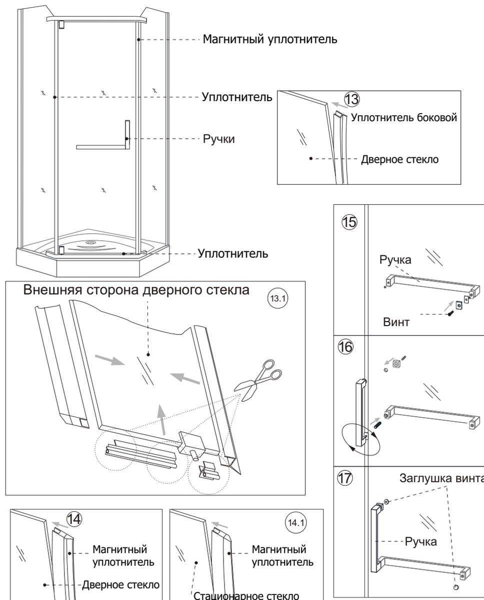
Установите дверные ручки, боковой, нижней и магнитные уплотнители на стеклянные полотна. Нижний уплотнитель необходимо подрезать обеспечив минимальные щели в нижней части.
