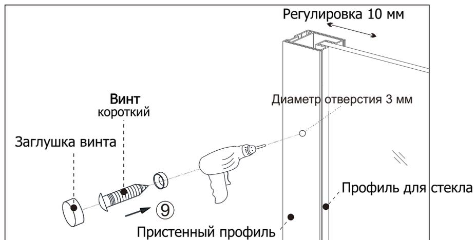
5.2) Установите каркас изделия в пристенные профили, отрегулируйте. Просверлите отверстия через два профиля с внутренней стороны и зафиксируйте конструкцию винтами с декоративной пластиковой крышкой.
