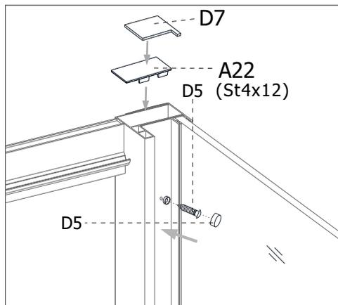
Соедините угловой профиль боковой панели с вертикальным профилем каркаса душевой двери. Сохраняя вертикальной положение отрегулируйте положение профилей и зафиксируйте винтами с заглушками, предварительно с внутренней стороны засверлив отверстие сверлом диаметром 3 мм.
