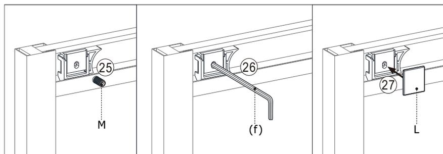
4.3) Сначала закрепите винт на ограничителе, затем вставьте ограничитель в направляющую из нержавеющей стали.
