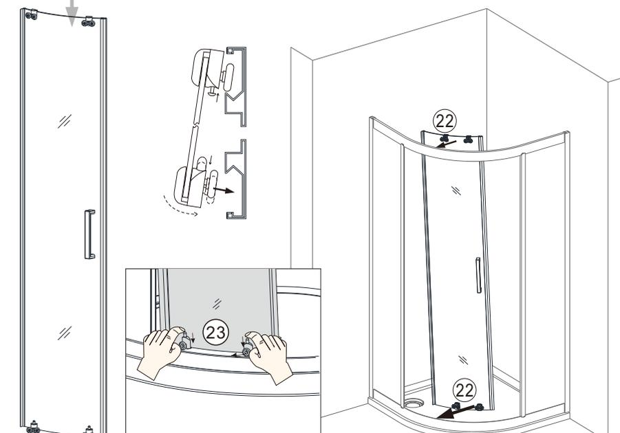
4.1) Закрепите ролики на скользящем стекле, закройте крышку колеса после регулировки. Установите водонепроницаемый уплотнитель и магнитный уплотнитель.
