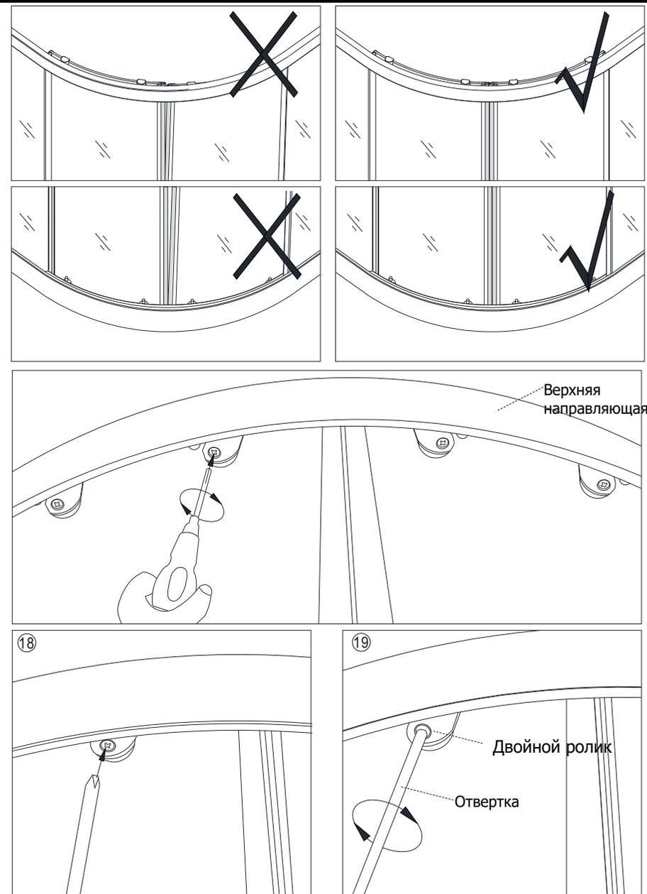
5.1) Пожалуйста, установите ролики раздвижной двери в алюминиевую направляющую. Если середина 2-х раздвижных дверей находится не по вертикали или, если после установки магнитного уплотнителя между 2-я дверьми имеется зазор, следует отрегулировать винт на роликах с помощью отвертки, чтобы 2-е раздвижные двери плотно прилегли друг к другу
