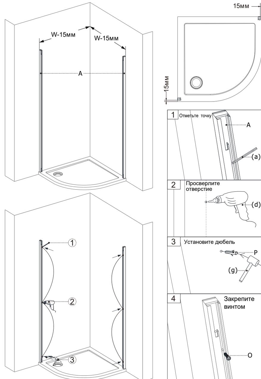
2.1) Отметьте 6 точек; Переместите душевой угол и просверлите отверстия, затем установите пластиковые дюбеля. Закрепите профиль на стене с помощью винта.
